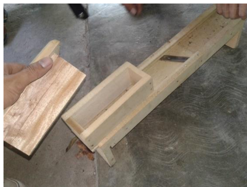
Gambar 1.2 Alat bantu pengiris serbaguna
