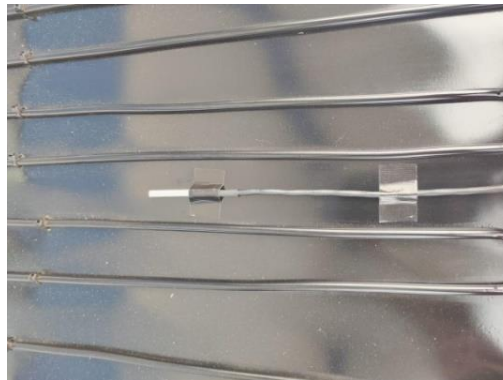
Gambar 4. 8 Pemasangan Sensor Suhu DS18B20 Pada Kolektor Pelat
