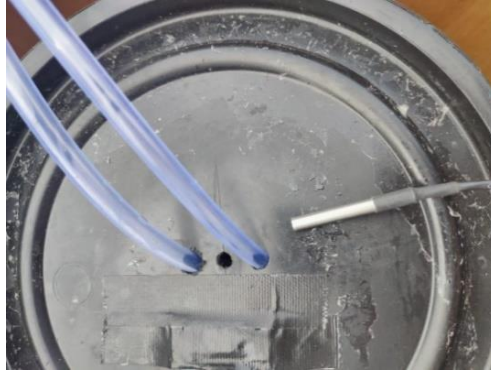
Gambar 4.9 Pemasangan Sensor Suhu DS18B20 Pada Tangki
