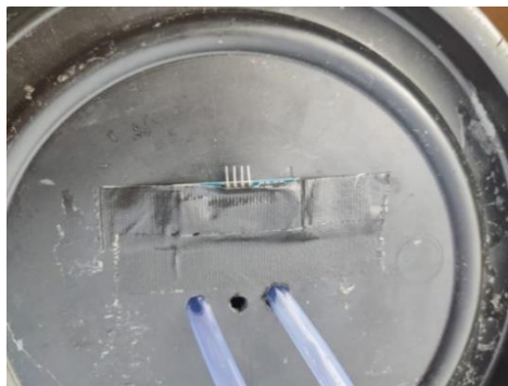
Gambar 4. 10 Pemasangan Sensor Ultrasonik
