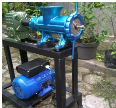
Gambar 2.3 Mesin pencetak pelet tipe horizontal dengan sistem penggerak motor listrik ( https://www.google.com )
