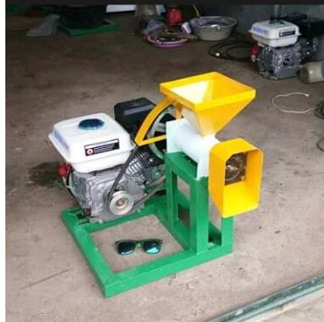
Gambar 2.2 Mesin pencetak pelet tipe horizontal dengan sistem penggerak motor bakar ( https://www.google.com )
