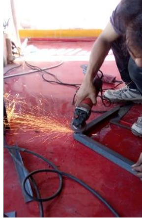
Gambar 3. 20 Proses Penghalusan Hasil Las
