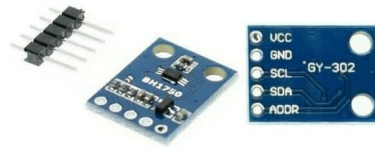
Gambar 2. 7 Bentuk fisik sensor intensitas cahaya GY-302 BH1750
