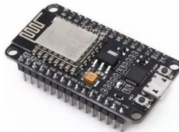
Gambar 2. 3 Bentuk fisik NodeMCU ESP8266
