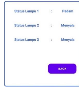
d. Tampilan smartphone jika lampu 1 dilepas, lampu 1 dan lampu 2 dipasang
