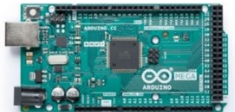
Gambar 2. 6 Bentuk fisik Arduino Mega
