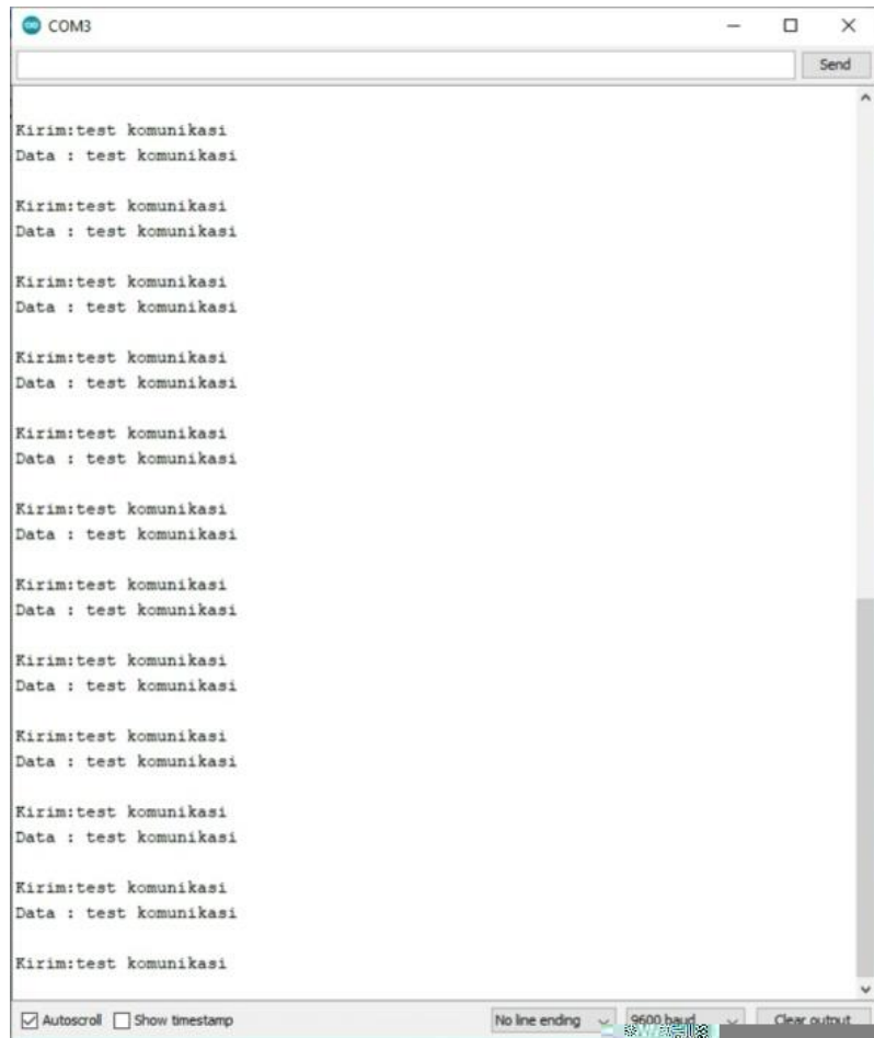
Gambar 4. 22 Hasil pengujian serial komunikasi antara Arduino Mega dan NodeMCU ESP8266 pada Arduino Mega
