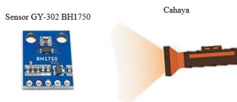
Gambar 4. 8 Ilustrasi pengujian modul sensor GY-302 BH1750
