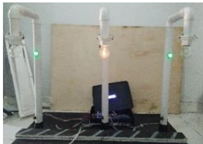
e. Kondisi flashing lamp jika lampu 1 dan lampu 3 dilepas, lampu 2 dipasang
