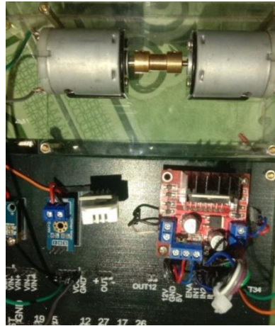
Gambar 4.27 Pemasangan Driver Motor & Motor
