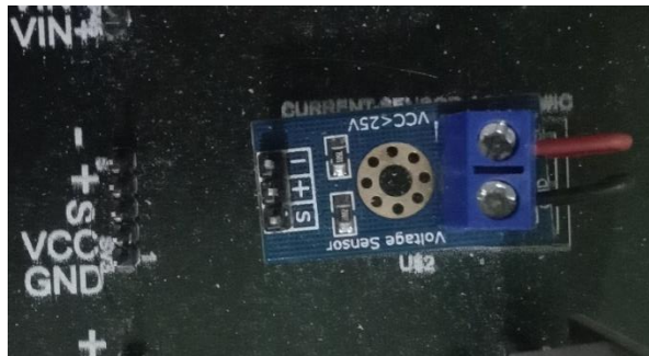
Gambar 4.23 Pemasangan Sensor Tegangan Pada Papan PCB
