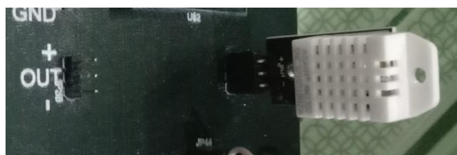
Gambar 4.13 Pemasangan Sensor DHT22 Pada Papan PCB
