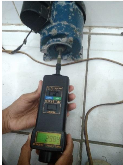
Gambar 4. 28 Pengukuran Kecepatan Motor Menggunakan Tachometer
