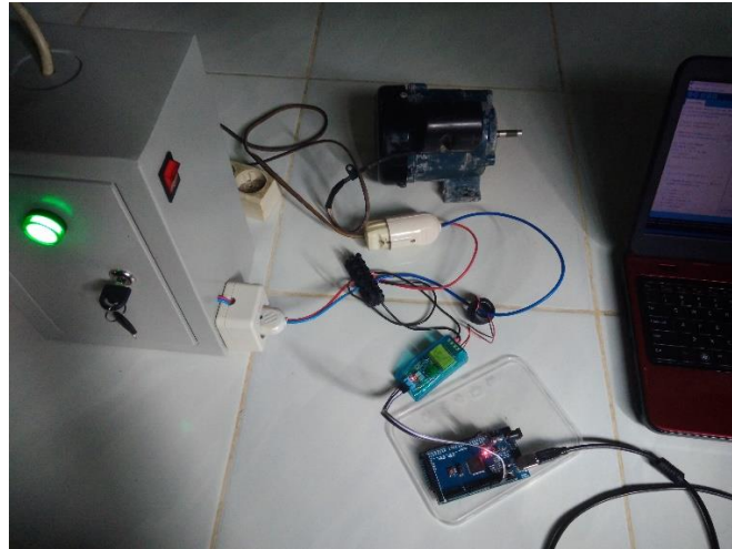
Gambar 4. 25 Pengukuran Menggunakan Sensor Pzem-004t
