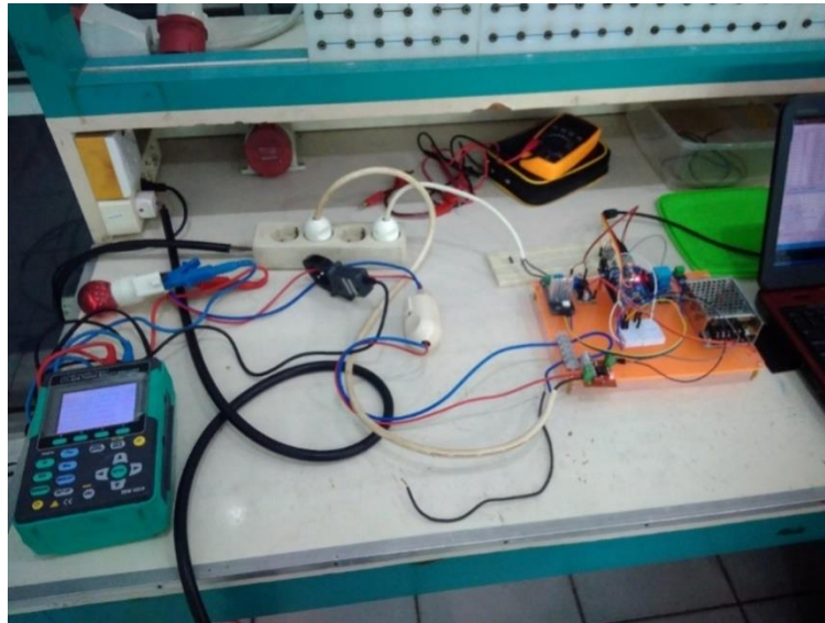
Gambar 4. 12 Proses Pengujian Rangkaian SSR dan TRIAC BTA16-600B
