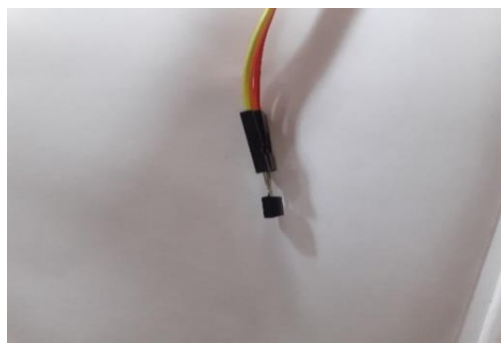
Gambar 4. 17 Pemasangan Sensor LM35
