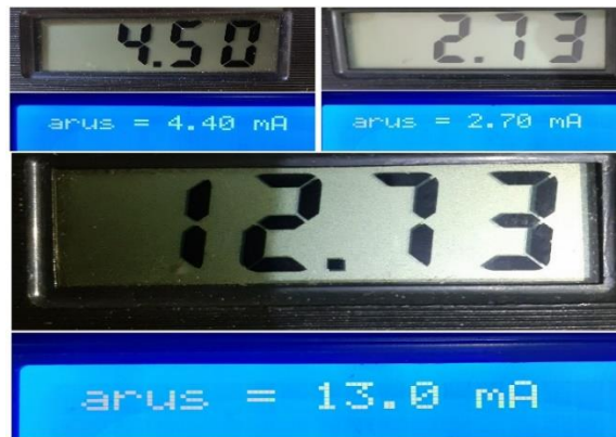
Gambar 4. 13 Hasil Pengujian sensor INA219 terhadap alat ukur multimeter
