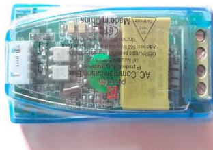
Gambar 4. 14 Pemasangan Sensor Pzem-004t
