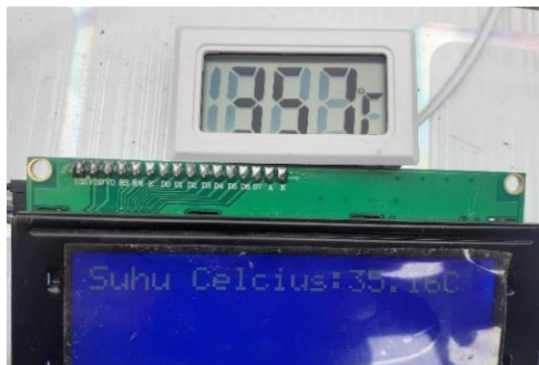
Gambar 4. 20 Hasil pengujian Sensor LM35 terhadap Thermometer digital
