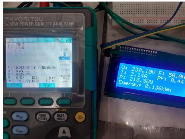
Gambar 4. 16 Hasil pengujian Sensor Pzem-004t terhadap alat ukur
