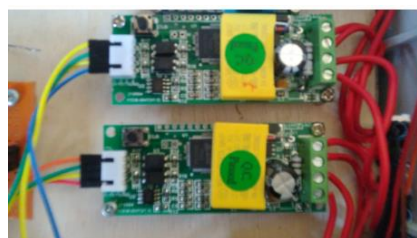
Gambar 4.14 Penempatan Modul PZEM-004T Pada Box Panel.
