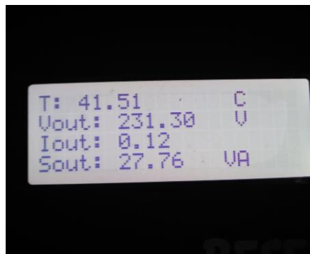
Gambar 4.34 Hasil Pengujian Arus dan Tegangan Pada LCD.
