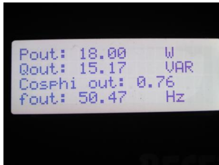
Gambar 4.33 Hasil Pengujian Daya Pada LCD.
