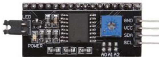
Gambar 2.9 Bentuk Fisik modul I2C LCD [12]
