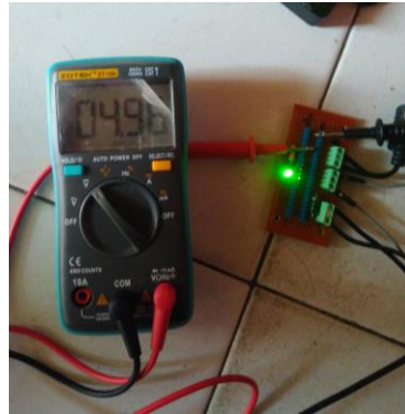
Gambar 4.7 Pengukuran Tegangan Catu Daya 5V DC
