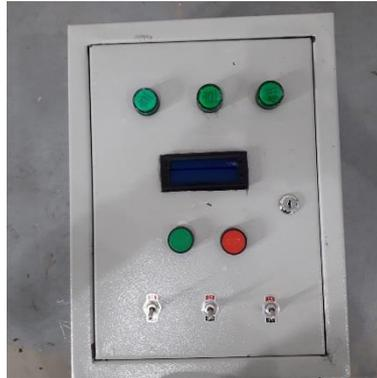
Gambar 4.11 *Box Panel* Sistem Proteksi
