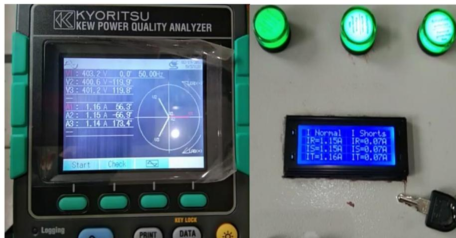
Gambar 4.10 Hasil Pengukuran Dengan Motor Induksi 3 Fasa
