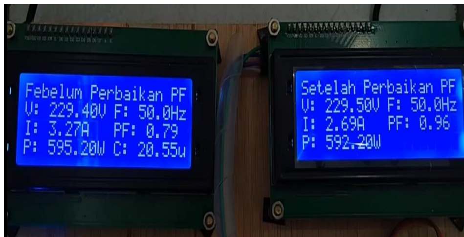
Gambar 4. 9 Hasil Sebelum dan Sesudah Perbaikan PF Gerinda Tangan + Motor Induksi
