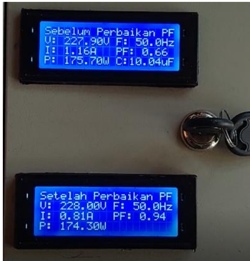
Gambar 4. 10 Hasil Sebelum dan Sesudah Perbaikan PF Pompa Air
