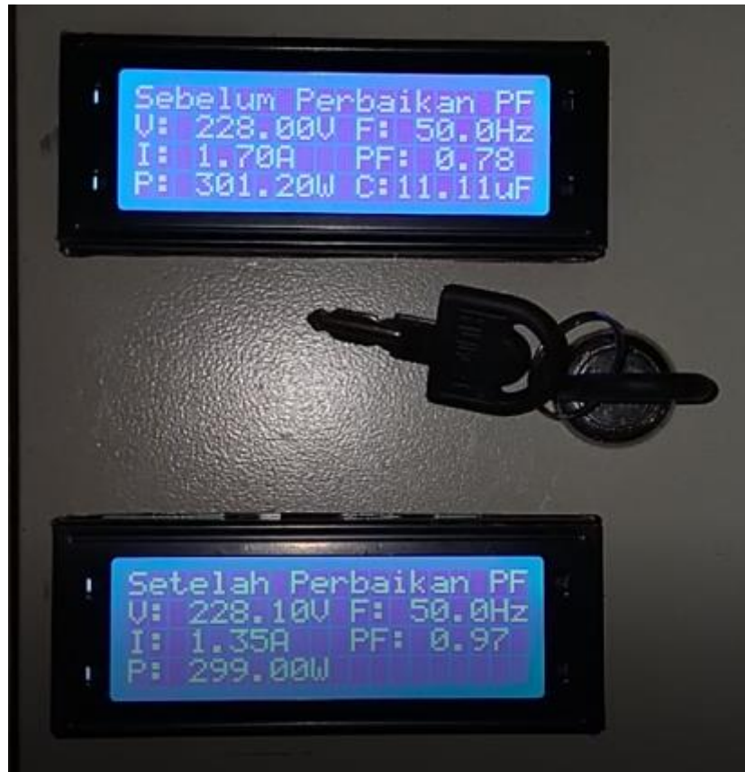
Gambar 4. 11 Hasil Sebelum dan Sesudah Perbaikan PF Pompa Air + Blender
