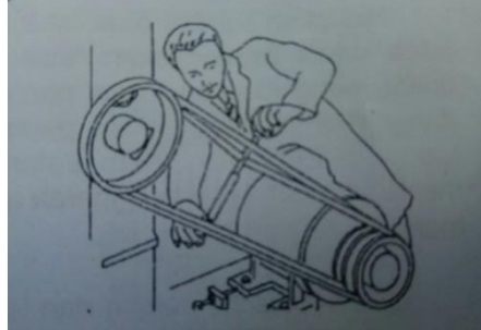
Gambar 3. 4 Contoh Pengukuran Defleksi Belt
