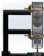
Gambar 4.23 Merakit Tiang *Clamping*
