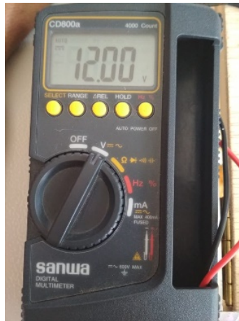
Gambar 4.58 Hasil Pengukuran Tegangan Masukan pada Kran Elektrik
