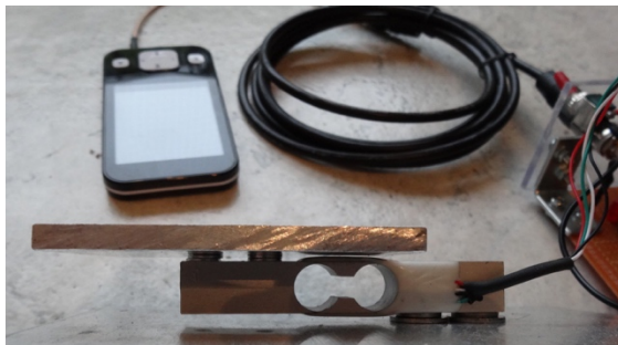
Gambar 4.36 Pemasangan Sensor Loadcell dan Modul hx711
