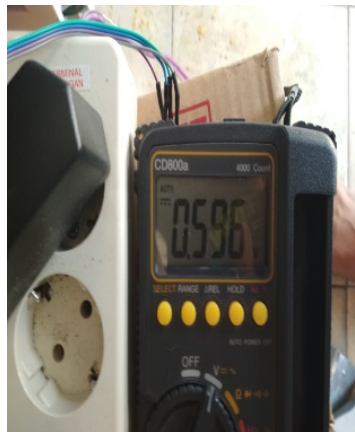
Gambar 4.59 Hasil Pengukuran Tegangan Outputan pada Motor Servo
