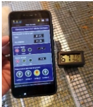
Gambar 4.56 Sample 2 hasil pengukuran pada aplikasi virtuino dan alat ukur
