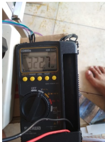
Gambar 4.60 Hasil Pengukuran Tegangan Outputan pada Sensor WLC
