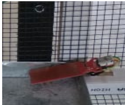
Gambar 4.40 Pemasangan Sensor Permukaan Air pada Tempat Minum
