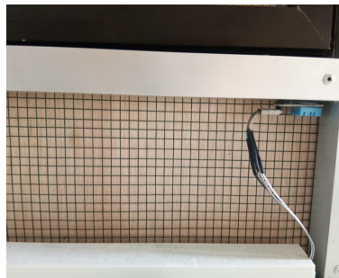
Gambar 4.32 Posisi 2 Sensor DHT 11 pada Kerangka Bagian Kecil.
