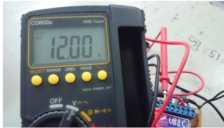
Gambar 4.24 Pengukuran Tegangan Catu Daya 12V DC
