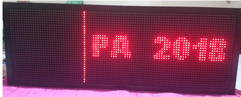
Gambar 4.21 Hasil Pengujian DMD P10 32x64
