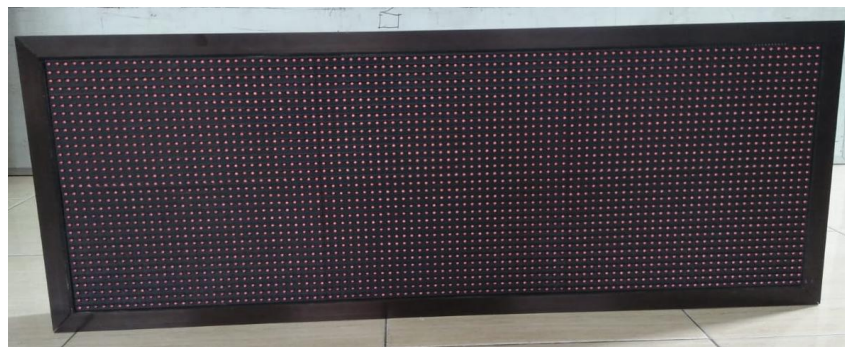
Gambar 4.16 Dot Matrix Display P10 yang telah terpasang pada alat Proyek akhir
