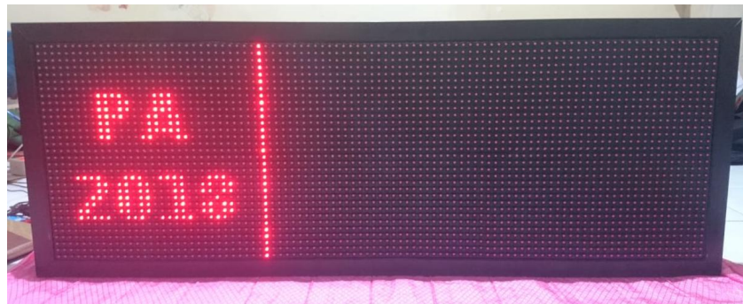
Gambar 4.20 Hasil Pengujian DMD P10 32x32
