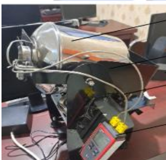
Gambar 2.4 Mesin sangrai kopi dengan menggunakan sensor thermocouple [8]
