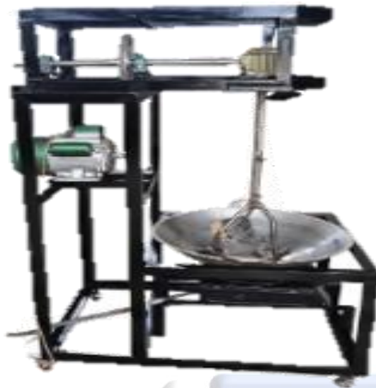
Gambar 2. 2 Mesin roasting kopi dengan pengaduk vertical [6]
