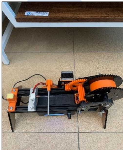
Gambar 3. 19 Proses Pembuatan Filament
