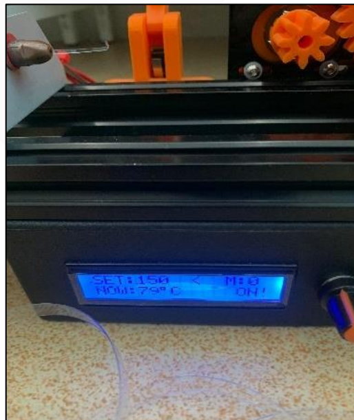
Gambar 3. 17 Proses Pengaturan Suhu Saat Strip Masuk ke Nozzle
