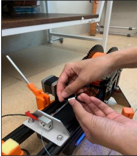
Gambar 3. 18 Proses Pengikatan Filament ke Tali Penggulungan
