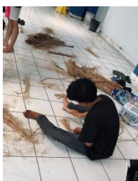
Gambar 4. Proses penyikatan serat
