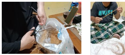
Gambar 8. Proses pemotongan serat sawit untuk persiapan benda uji
