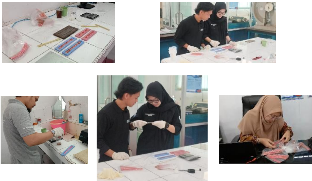
Gambar 12. Proses pembuatan benda uji tarik dan uji lentur
