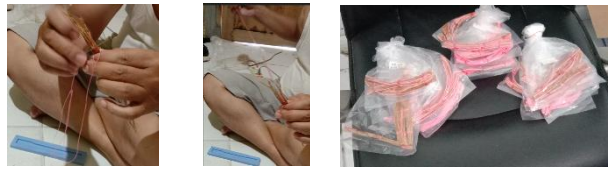
Gambar 10. Proses penjahitan serat sawit dan benang UHMWPE
