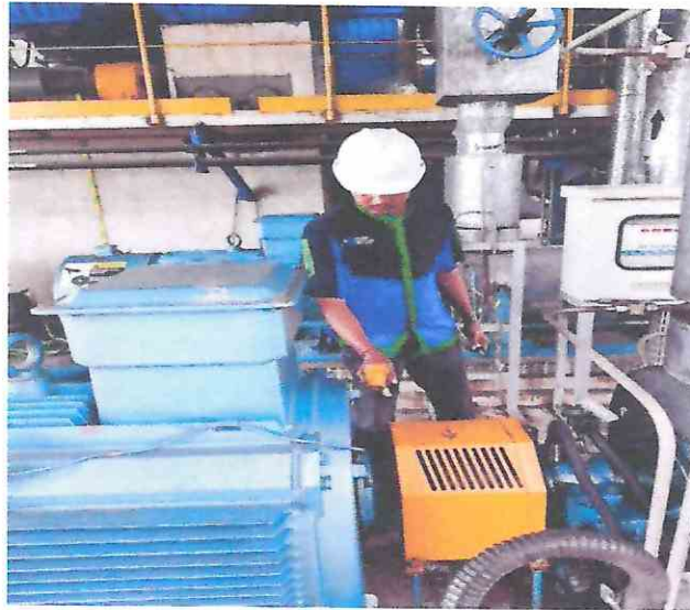
Gambar 2.12 Pengambilan suhu dan vibrasi
