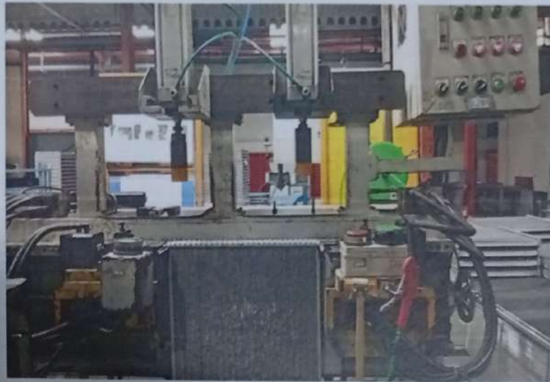
Gambar 1.12 Mesin Crimping Pemasangan Tangki
