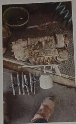
Gambar 2.2 Pembersihan Injeksi Pump
