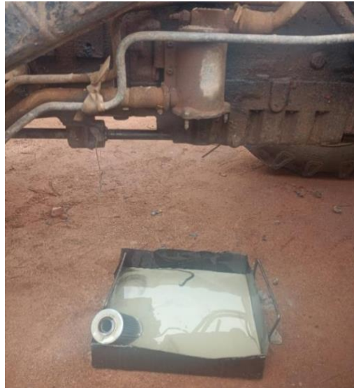
Gambar 2. 22 Ganti Filter Transmisi Traktor Landini 8860
