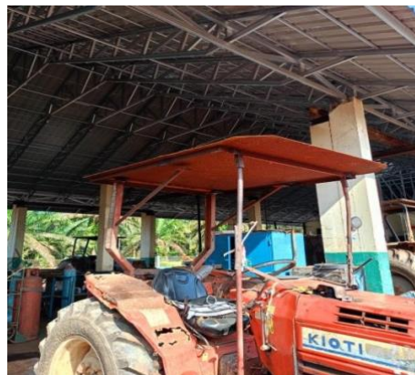
Gambar 2. 15 Ganti Atap Kabin Traktor Kioti 3503-D
