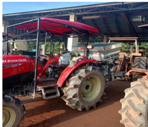
Gambar 2. 16 Rakit Verion Alat Pemupukan Otomatis
