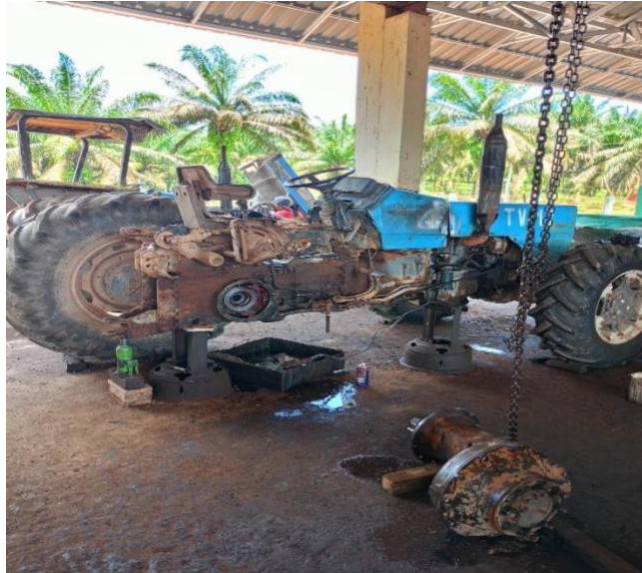
Gambar 2. 3 Ganti kampas rem traktor landini 8860
