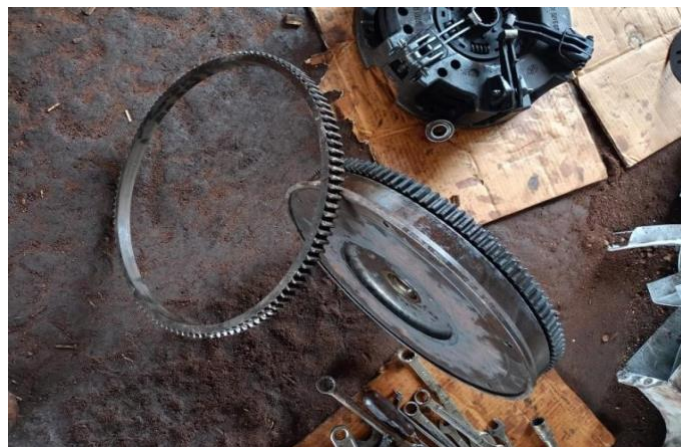
Gambar 2. 11 Ganti Ring Gear Traktor Landini 8860
