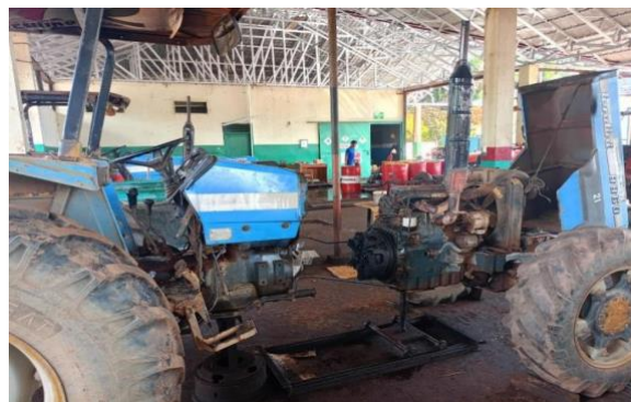
Gambar 2. 13 Ganti Kopling Traktor Landini 8860
