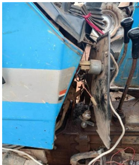
Gambar 2. 21 Pebaiki Perkabelan Traktor Landini 8860
