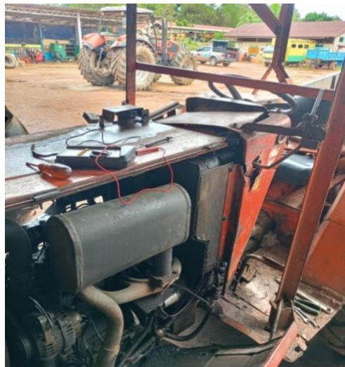
Gambar 2. 23 Perbaiki Perkabelan Traktor Kioti 3503-D
