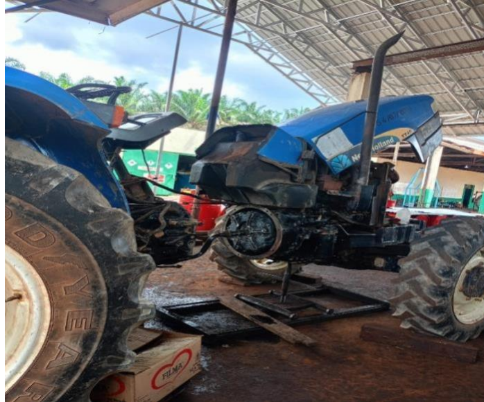
Gambar 2. 2 Ganti kopling traktor New Holland TT45
