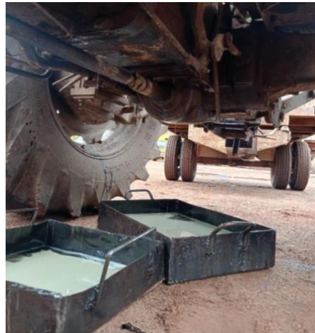
Gambar 2. 20 Ganti Oli Transmisi Traktor Landini 8860
