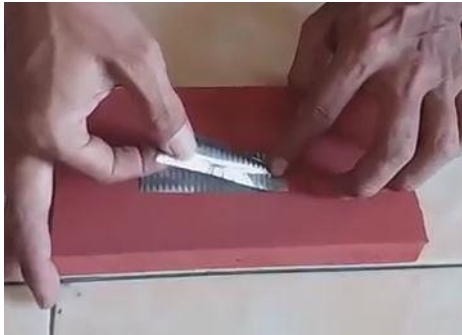
Gambar 1.5. Pelapisan sisi kedua metal jig
