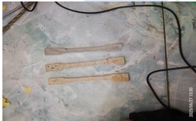
Gambar 4.5 Sampel uji tarik 4,5gr talc resin
