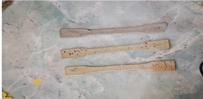
Gambar 4.4 Sampel uji tarik 3gr talc resin
