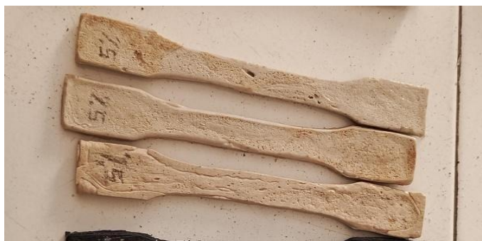
Gambar 4.3 Sampel uji tarik 1,5gr talc resin
