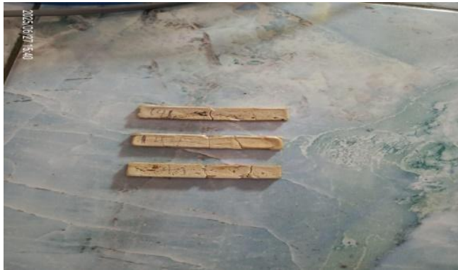
Gambar 4.8 Sampel uji impak 2,25gr talc resin
