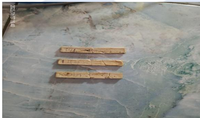
Gambar 4.7 Sampel uji impact 1,5gr talc resin
