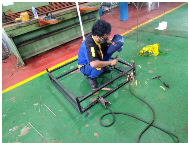
Gambar 4. 6 Proses pembuatan Landasan Mesin
