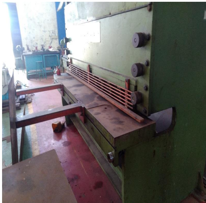
Gambar 4. 1 Mesin Potong Pelat
