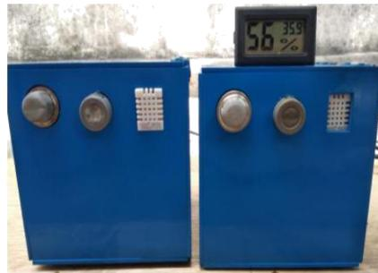
Gambar 4.21 Perbandingan box sensor dengan alat ukur pukul 13:02
