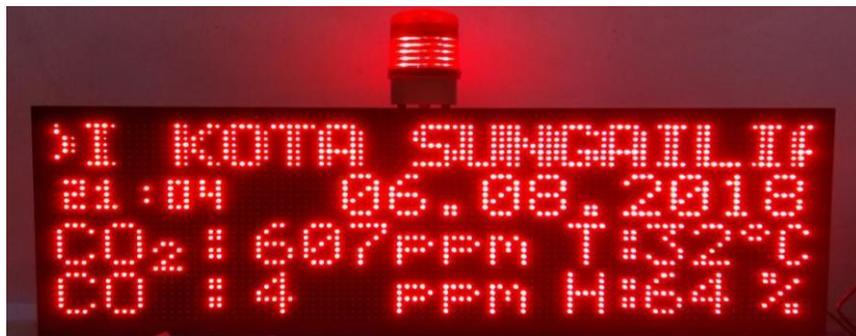
Gambar 4.44 Tampilan pada *LED* Dot Matrix saat Sensor diberikan Gas Korek Api
