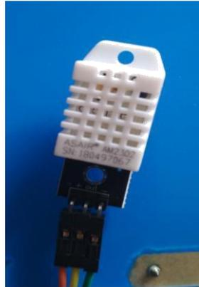
Gambar 4.18 Sensor DHT 22
