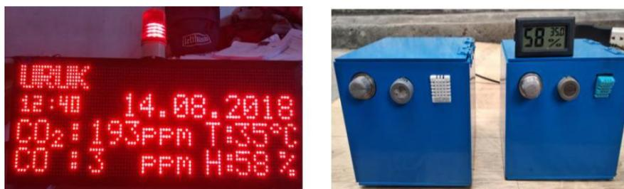
Gambar 4.20 Perbandingan box sensor dengan alat ukur pukul 12:40
