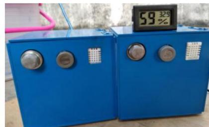
Gambar 4.23 Perbandingan box sensor dengan alat ukur pukul 17:22
