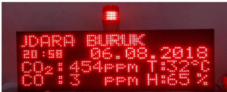
Gambar 4.40 Tampilan pada *LED* Dot Matrix saat Sensor diberikan Asap Daun Kering
