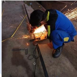
Gambar 4. 19 Pemotongan Besi *Hollow*
