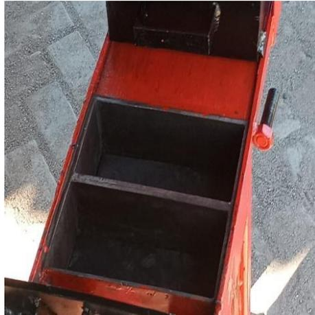
Gambar 3.3 Cetakan Bata Beton (Dok. Pribadi)
