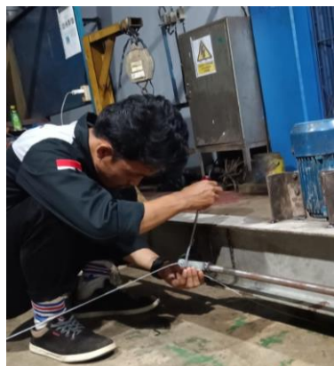
Gambar 4.12 Proses pemasangan Sling
