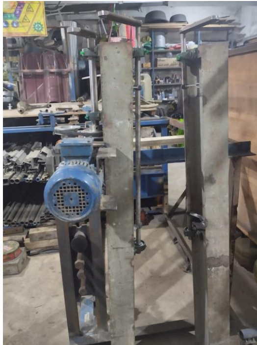
Gambar 4.9 Proses Pemasangan Poros (As) Penggerak.
