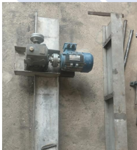
Gambar 4.7 Proses Pemasangan kopling Motor Listrik dan Gearbox .
