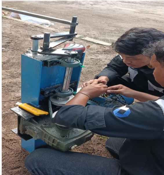
Gambar 4.14 Proses pemasangan kabel penghubung motor listrik
