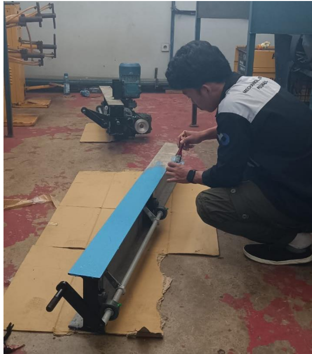
Gambar 4. 13 Proses pengecatan bagian rangka
