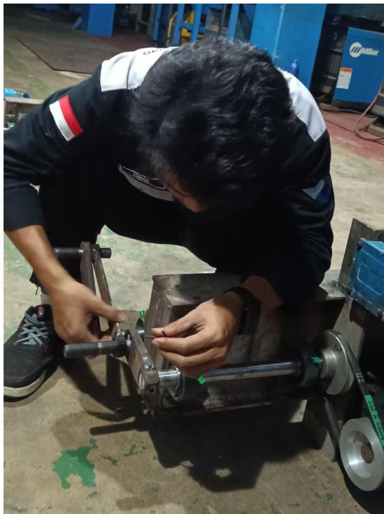
Gambar 4. 10 Proses pemasangan plat penghubung.
