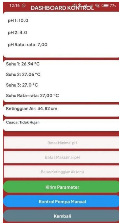
Gambar 4. 16 Pembacaan Data Realtime Oleh Aplikasi Smartphone diatas menunjukkan bahwa aplikasi mampu membaca data secara realtime dari *firebase* dan ESP 32. Dapat disimpulkan bahwa proses transfer data dari arduino > ESP 32 > *Firestore* > *Software*.
