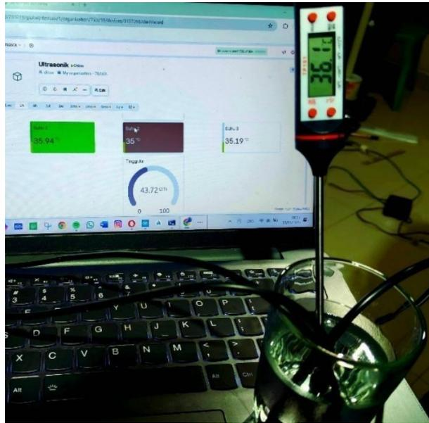
c. Pengujian sensor suhu pada air dingin
