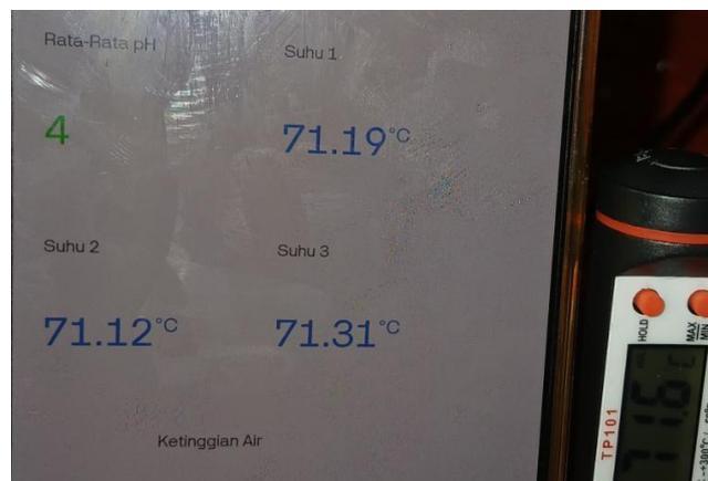
b. Pengujian sensor suhu pada air hangat
