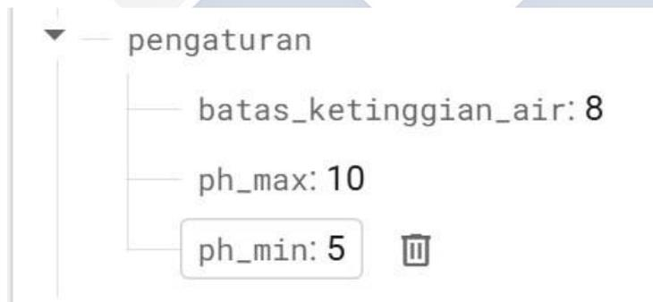
Gambar 4. 17 Tampilan Pembacaan Perintah Parameter Dari Software Diatas merupakan pembacaan database dari perintah parameter pH dan ketinggian air yang dikirim oleh *software*.
