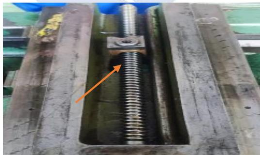
*Gambar 4.2 Komponen Nut Screw yang tidak lengkap*
