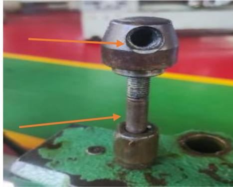
Gambar 4.5 Komponen *Handle* dan *Bushing* yang tidak lengkap
