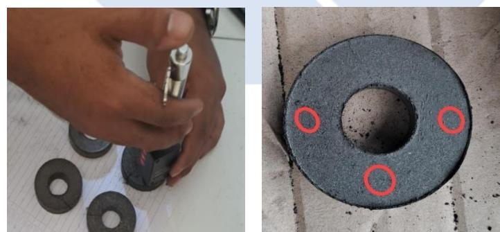
Gambar 4. 8 Proses pengujian kekerasan pada sampel
