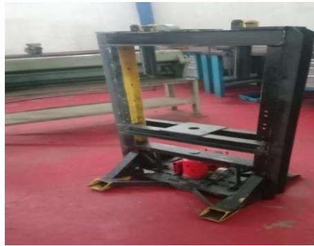
Gambar 3. 8 Mesin press hidrolik
