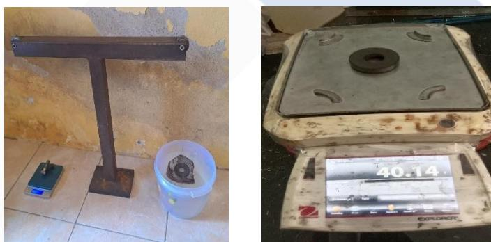
Gambar 4. 7 Proses pengujian densitas pada sampel
