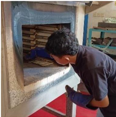
Gambar 3.24. Proses Pengovenan Spesimen
