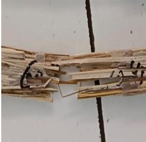
Gambar 4.5. Struktur makro spesimen nilai tarik terendah
