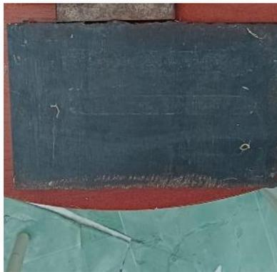
Gambar 3.19. Pengolesan landasan dan cetakan dengan wax
