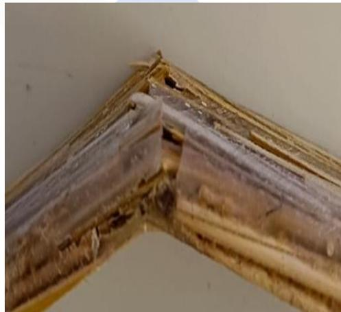
Gambar 4.11. Struktur makro spesimen nilai lentur terendah
