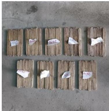
Gambar 4.1. Spesimen Uji Tarik
