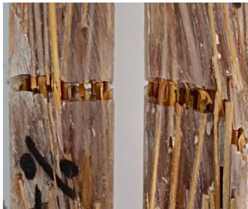
Gambar 4.10. Struktur makro spesimen nilai lentur tertinggi
