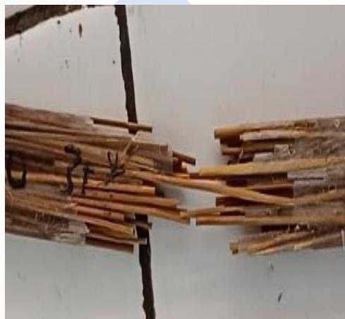
Gambar 4.4. Struktur makro spesimen nilai tarik tertinggi
