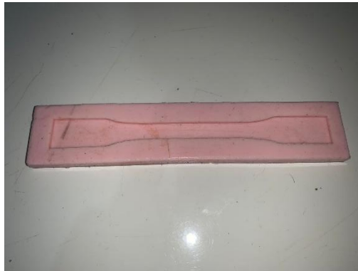
Gambar 3.6 Cetakan Spesimen Uji Tarik ASTM D638 Tipe 1
