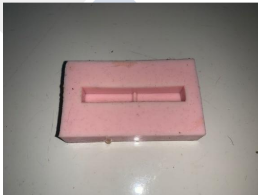
Gambar 3.7 Cetakan Spesimen Uji Impak ASTM D256
