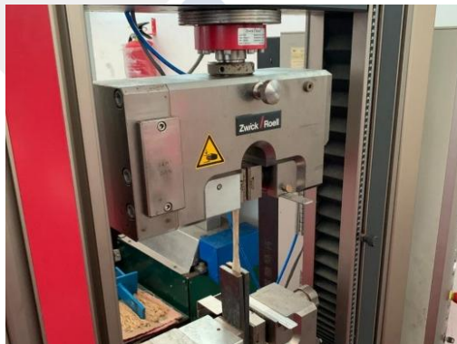
Gambar 4.1 Pengujian Spesimen Uji Tarik
