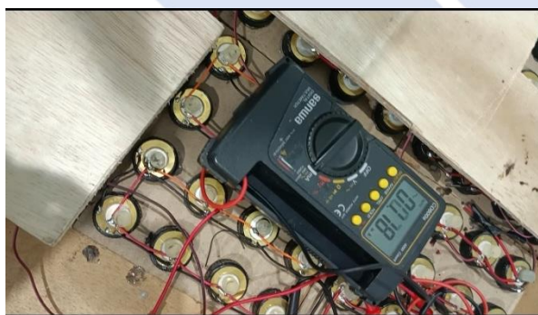
Gambar 4. 31 Pengujian 3 Konfigurasi Paralel-Seri Pengukuran Arus
