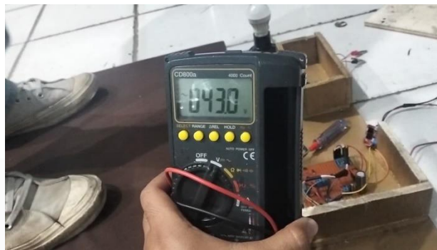
Gambar 4. 41 Pengujian Blok 8 Dengan Massa 98kg Pengukuran Tegangan
