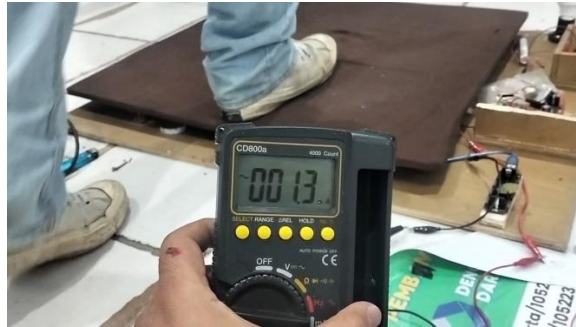
Gambar 4. 42 Pengujian menggunakan massa 98kg dan beban 1 ohm pada pengukuran arus dengan metode melintas
