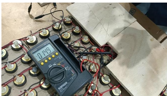
Gambar 4. 15 Pengujian 2 Konfigurasi Paralel-Paralel Pengukuran Arus
