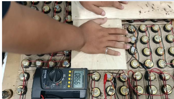
Gambar 4. 5 Pengujian 1 Konfigurasi Seri-Seri Pengukuran Arus
