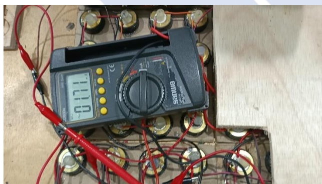
Gambar 4. 20 Pengujian 1 Konfigurasi Seri-Paralel Pengukuran Arus
