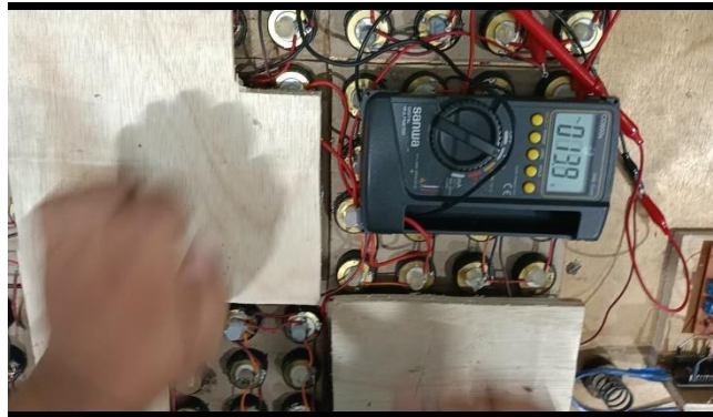
Gambar 4. 18 Pengujian 1 Konfigurasi Seri-Paralel Pengukuran Tegangan
