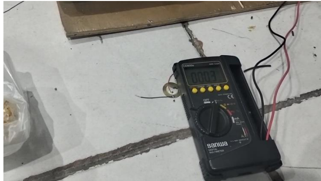
Gambar 4. 38 Pengujian Blok 4 Dengan Massa 69kg Pengukuran Tegangan
