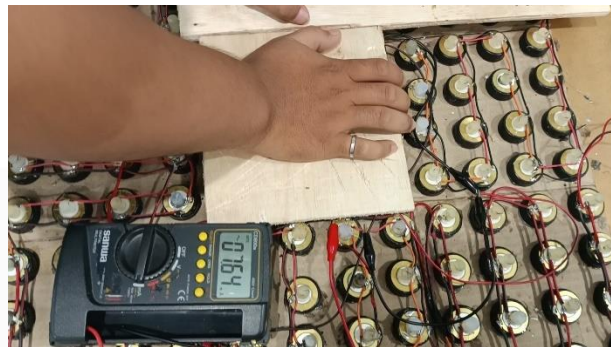
Gambar 4. 10 Pengujian 3 Konfigurasi Seri-Seri Pengukuran Arus
