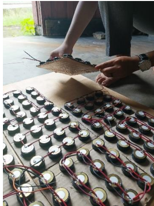
Gambar Lampiran 3. 10 Proses Penempelan Konfigurasi piezoelektrik ke Alas
