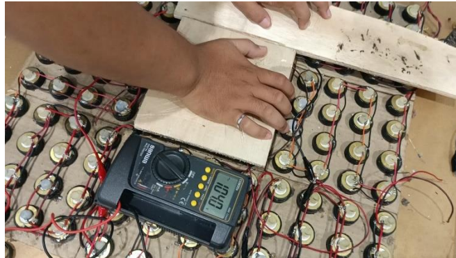
Gambar 4. 6 Pengujian 2 Konfigurasi Seri-Seri Pengukuran Tegangan
