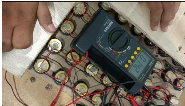
Gambar 4. 29 Pengujian 2 Konfigurasi Paralel-Seri Pengukuran Arus
