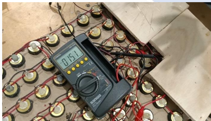
Gambar 4. 12 Pengujian 1 Konfigurasi Paralel-Paralel Pengukuran Arus
