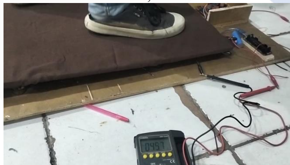
Gambar 4. 34 Pengujian Blok 1 Dengan Massa 69kg Pengukuran Tegangan
