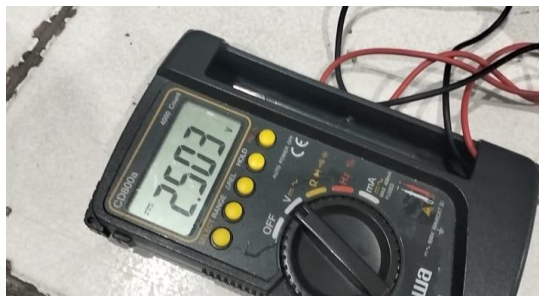
Gambar 4. 58 Pengukuran Tegangan Akhir Baterai
