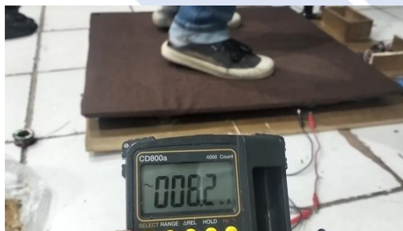
Gambar 4. 37 Pengujian Blok 2 Dengan Massa 69kg Pengukuran Arus
