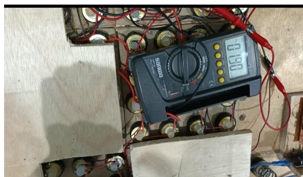
Gambar 4. 24 Pengujian 3 Konfigurasi Seri-Paralel Pengukuran Arus
