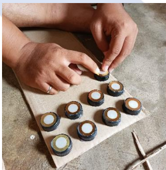
Gambar Lampiran 3. 3 Pemasangan Piezoelektrik ke Alas
