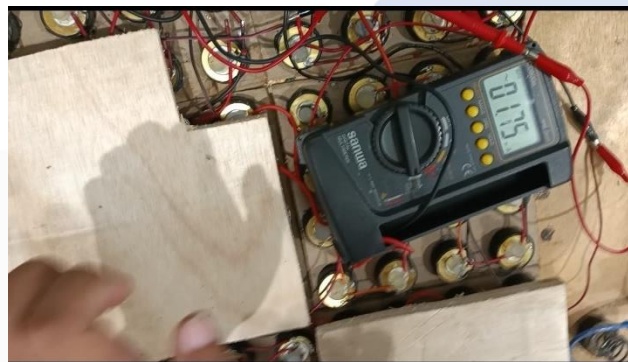
Gambar 4. 22 Pengujian 2 Konfigurasi Seri-Paralel Pengukuran Arus
