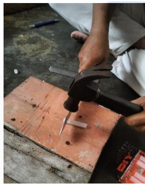
Gambar Lampiran 3. 11 Proses Pemotongan Lem Lilin
