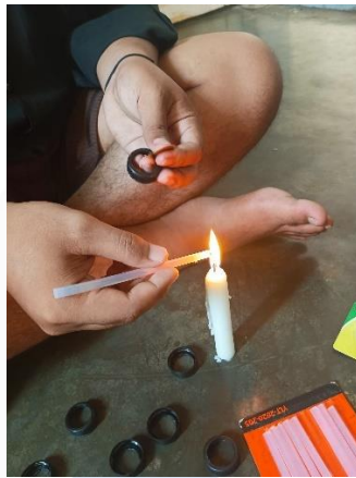
Gambar Lampiran 3. 2 Pemasangan Piezoelektrik ke Tutup Botol
