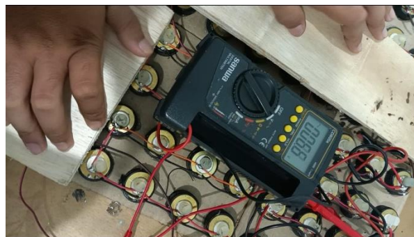
Gambar 4. 28 Pengujian 2 Konfigurasi Paralel-Seri Pengukuran Tegangan
