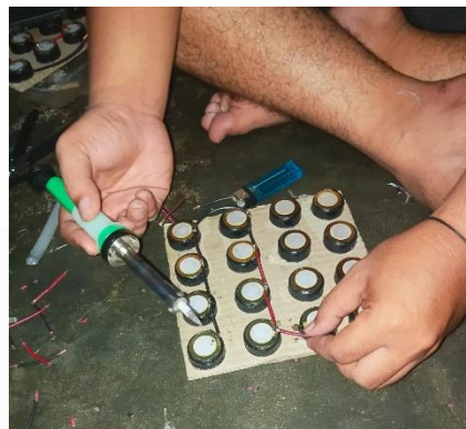
Gambar Lampiran 3. 5 Proses Penyolderan
