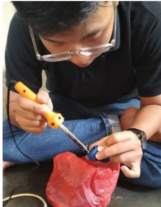
Gambar Lampiran 3. 1 Pelubangan Tutup Botol
