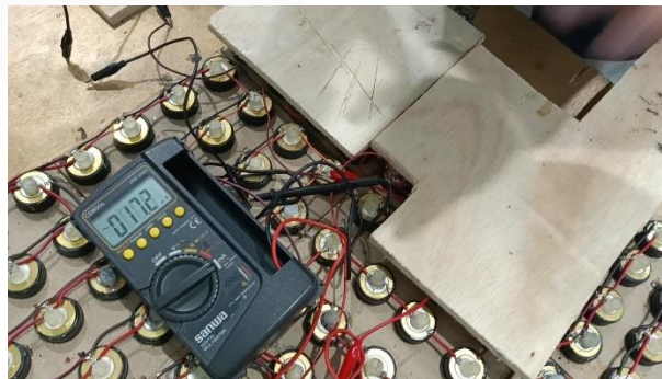
Gambar 4. 17 Pengujian 3 Konfigurasi Paralel-Paralel Pengukuran Arus
