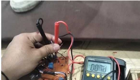
Gambar 4. 46 Pengujian menggunakan massa 98kg dan beban rangkaian pengecasan pada pengukuran tegangan dengan metode melompat
