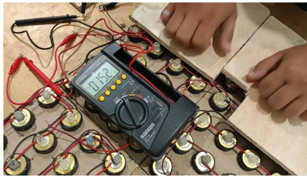
Gambar 4. 16 Pengujian 3 Konfigurasi Paralel-Paralel Pengukuran Tegangan
