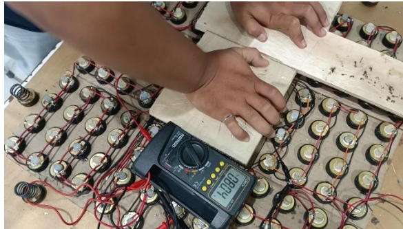
Gambar 4. 4 Pengujian 1 Konfigurasi Seri-Seri Pengukuran Tegangan
