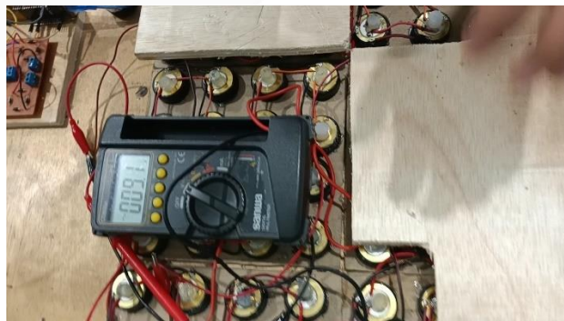
Gambar 4. 23 Pengujian 3 Konfigurasi Seri-Paralel Pengukuran Tegangan
