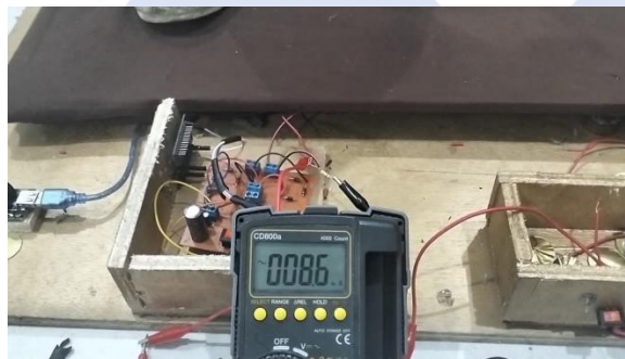
Gambar 4. 45 Pengujian menggunakan massa 98kg dan beban rangkaian pengecasan pada pengukuran arus dengan metode melompat
