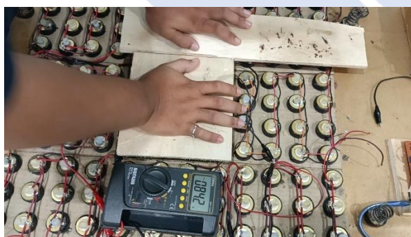
Gambar 4. 8 Pengujian 3 Konfigurasi Seri-Seri Pengukuran Tegangan
