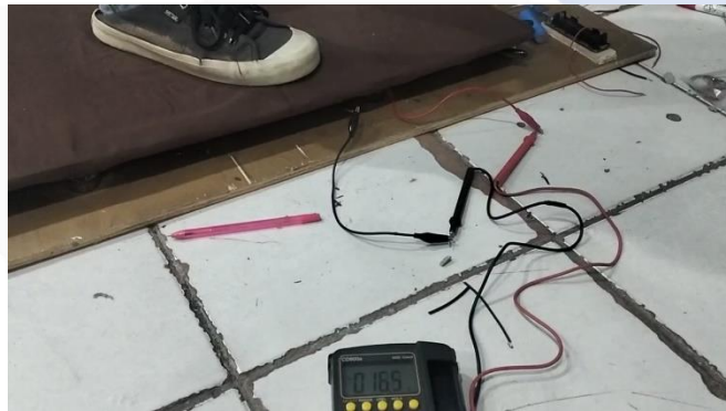
Gambar 4. 36 Pengujian Blok 2 Dengan Massa 69kg Pengukuran Tegangan
