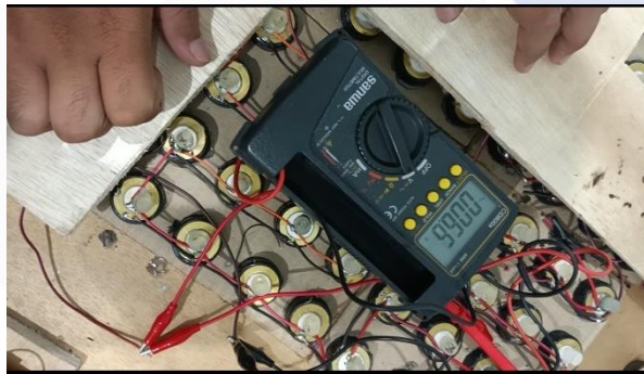
Gambar 4. 30 Pengujian 3 Konfigurasi Paralel-Seri Pengukuran Tegangan
