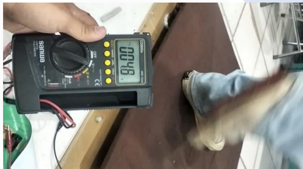
Gambar 4. 43 Pengujian menggunakan massa 98kg pada rangkaian terbuka pengukuran tegangan dengan metode melintas
