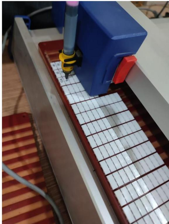
Gambar 2. 31 Proses Pencetakan *Marking* Terminal
