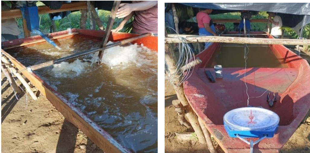
Gambar 4. 31 proses pengujian gaya dorong
