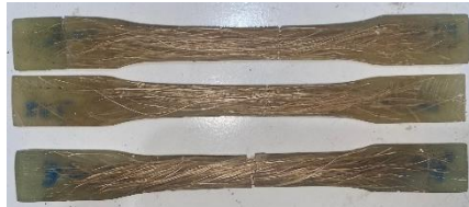
Gambar 4. 3 Spesimen Setelah Dilakukan Uji Tarik
