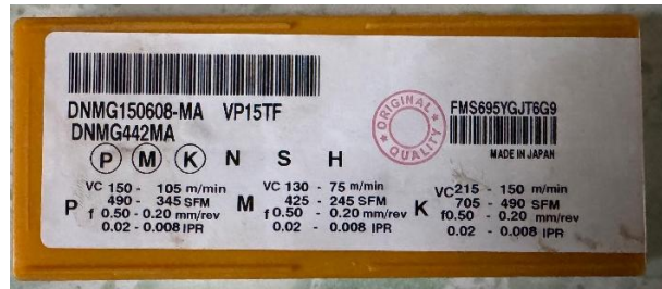
Gambar 3. 5 Spesifikasi Mata Potong DNMG
