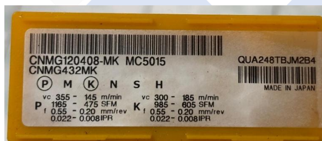
Gambar 3. 4 Spesifikasi Mata Potong CNMG
