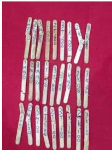
Gambar 4. 3 Spesimen Setelah Uji Tarik.
