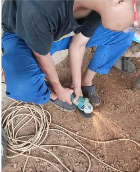
Gambar 4 1 Pemotongan Besi Siku
