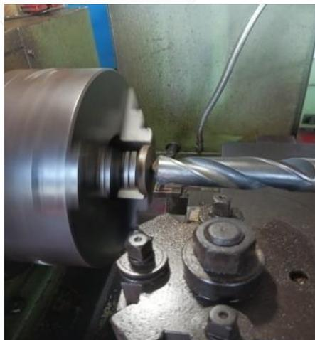
Gambar 4 11 Pembuatan Pengikat Pipa *Steinless*
