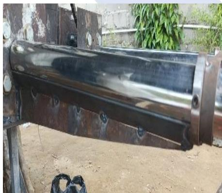
Gambar 4 19 Pemasangan Penahan Pipa dan Pengikat
