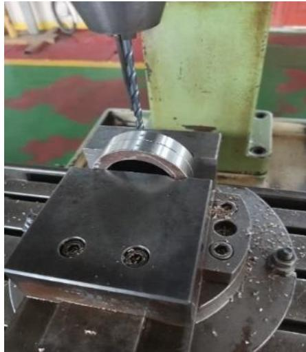
Gambar 4 12 Pembuatan Lubang Pada Penahan Pipa
