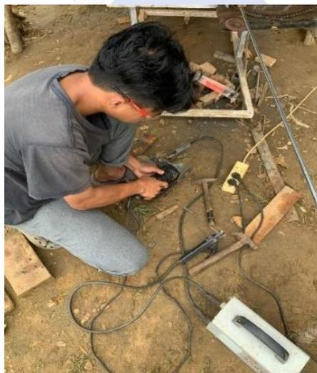
Gambar 4 5 Pemotongan Plat
