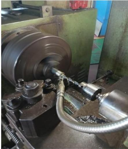
Gambar 4 10 Pengeboran Poros Menggunakan Mesin Bubut
