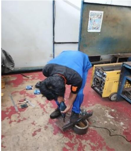
Gambar 4 7 Pengeboran Lubang Untuk Menempel Bering
