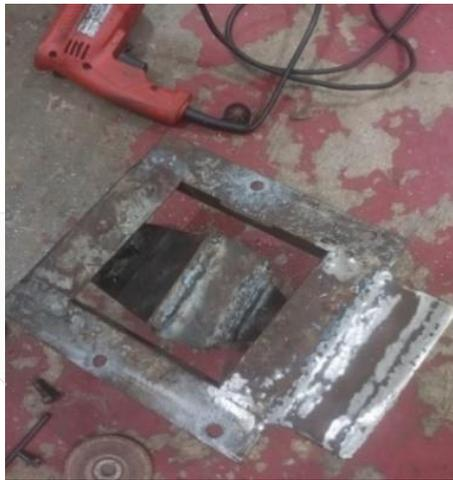
Gambar 4 3 Pengeboran Lubang Baut Pada Dudukan
