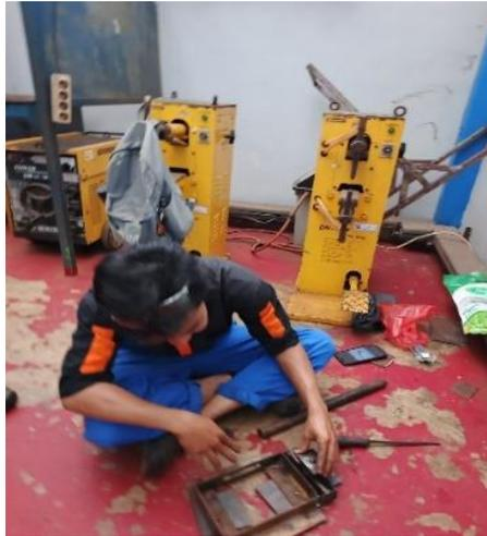
Gambar 4 4 Pemasangan Ensel Pada Dudukan Mesin
