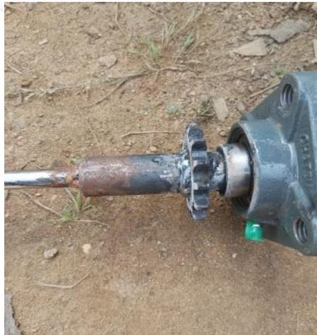
Gambar 4 17 Pemasangan *Sprocket*
