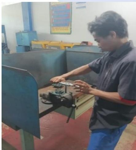
Gambar 4 8 Pengetapan Lubang Bering Menjadi Ulur
