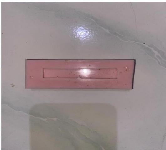
Gambar 3. 2 Cetakan Uji Bending
