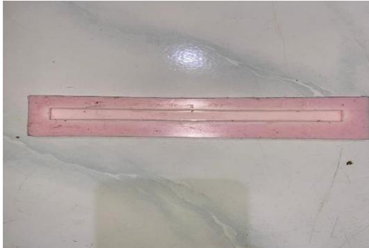
Gambar 3. 1 Cetakan Uji Bending
