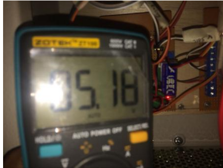
Gambar 4.64 Hasil Pengujian Tegangan Catu Daya 5 V
