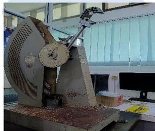
Gambar 3. 11 Mesin Uji Impak
