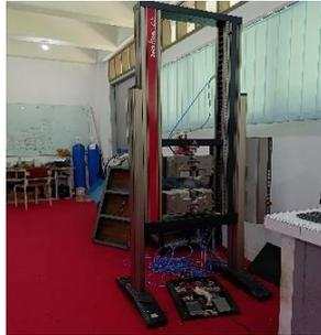
Gambar 3. 12 Mesin Uji Bending
