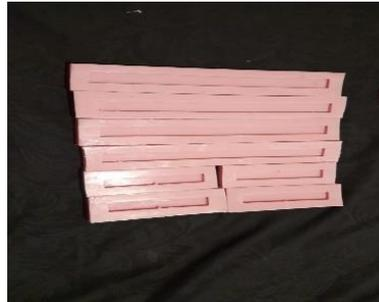
Gambar 3. 10 Cetakan Uji Impak dan Uji Bending
