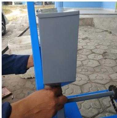
**Gambar 4. 24** Proses Perakitan *Hopper*
