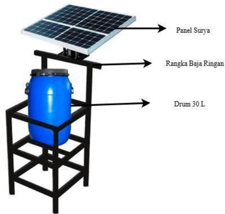
Gambar 3. 4 Desain Rangka dan Peletakan Komponen Utama
