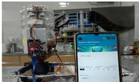
Gambar 2. 1 Desain pengembangan Smart fish feeder menggunakan ESP32 dan aplikasi Blynk.
