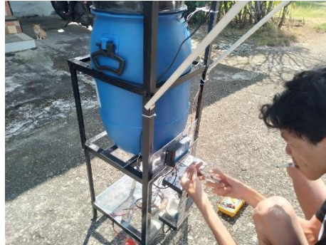
Gambar 4. 17 Proses Pengukuran Kinerja Sistem PV dalam Pengisian Aki
