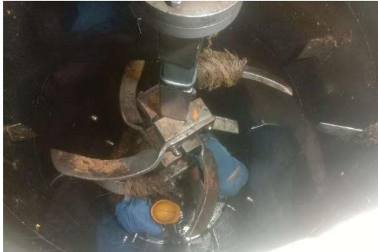
Gambar 2. 13 Pergantian Baut Pengikat *Expeler Digester*
