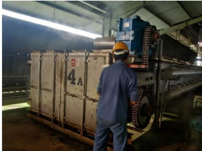
Gambar 2. 8 Pergantian Rantai Transmisi *Gear Box CS*
