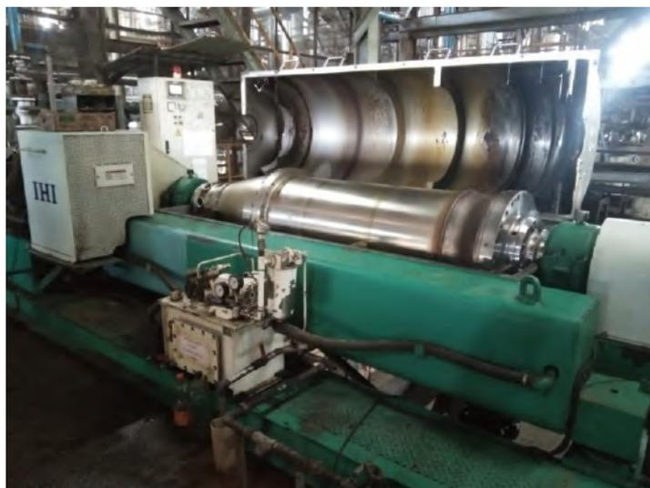
Gambar 2. 19 Mesin *Decanter*
