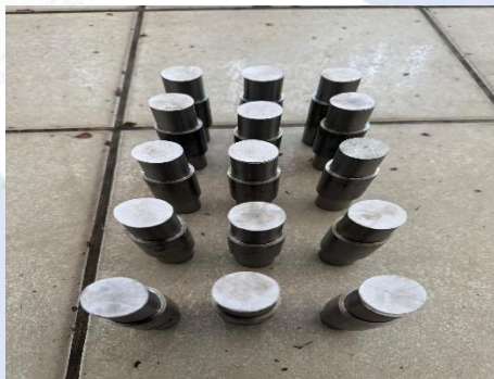
Gambar 3. 11 Spesimen Uji Setelah Dibubut
