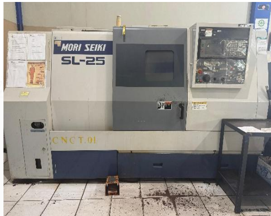
Gambar 3. 4 Mesin CNC Turning Mori Seiki SL-25
