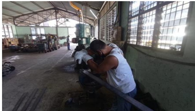
Gambar 2.7 Bor plate strip untuk ring ducting inlet FFB conditioner
