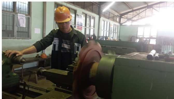
Gambar 2.6 Bubut sprocket gear untuk moving floor conveyor
