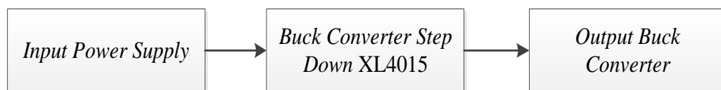
Gambar 4.20. Blok Pengujian Buck Converter
